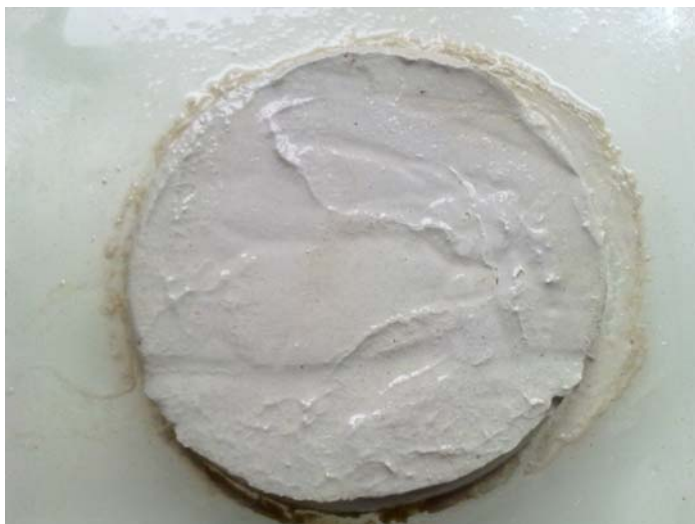
Joonis 4.4 Katsekeha B2 pärast 20 päeva vees olemist
