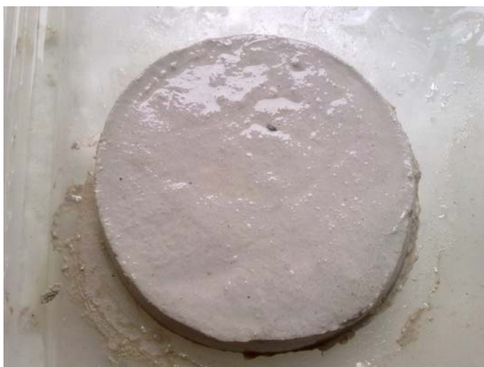
Joonis 4.3 Katsekeha B1 pärast 20 päeva vees olemist
