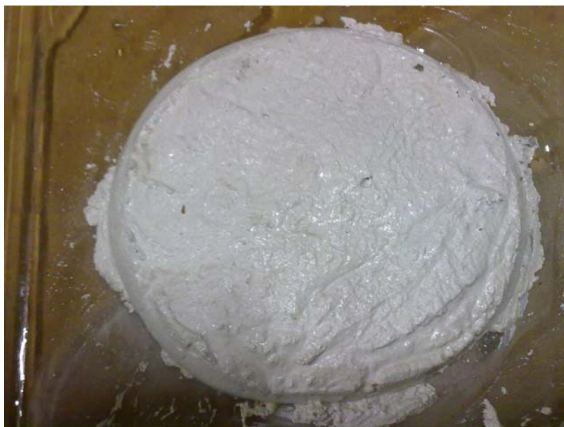
Joonis 3.10 Riigi karjääri lubjast valmistatud katsekeha A1 enne vette panekut
