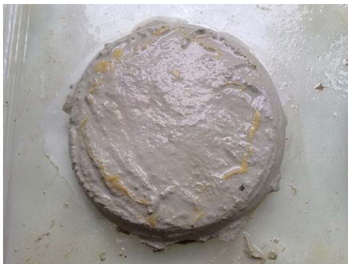
Joonis 4.1 Katsekeha A1 pärast 20 päeva vees olemist
