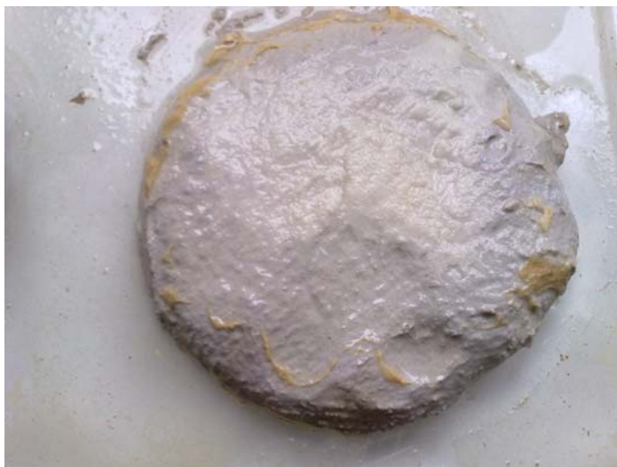
Joonis 4.2 Katsekeha A2 pärast 20 päeva vees olemist
