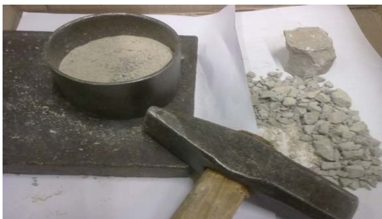
Joonis 2.2 Kivide purustamine haamriga
