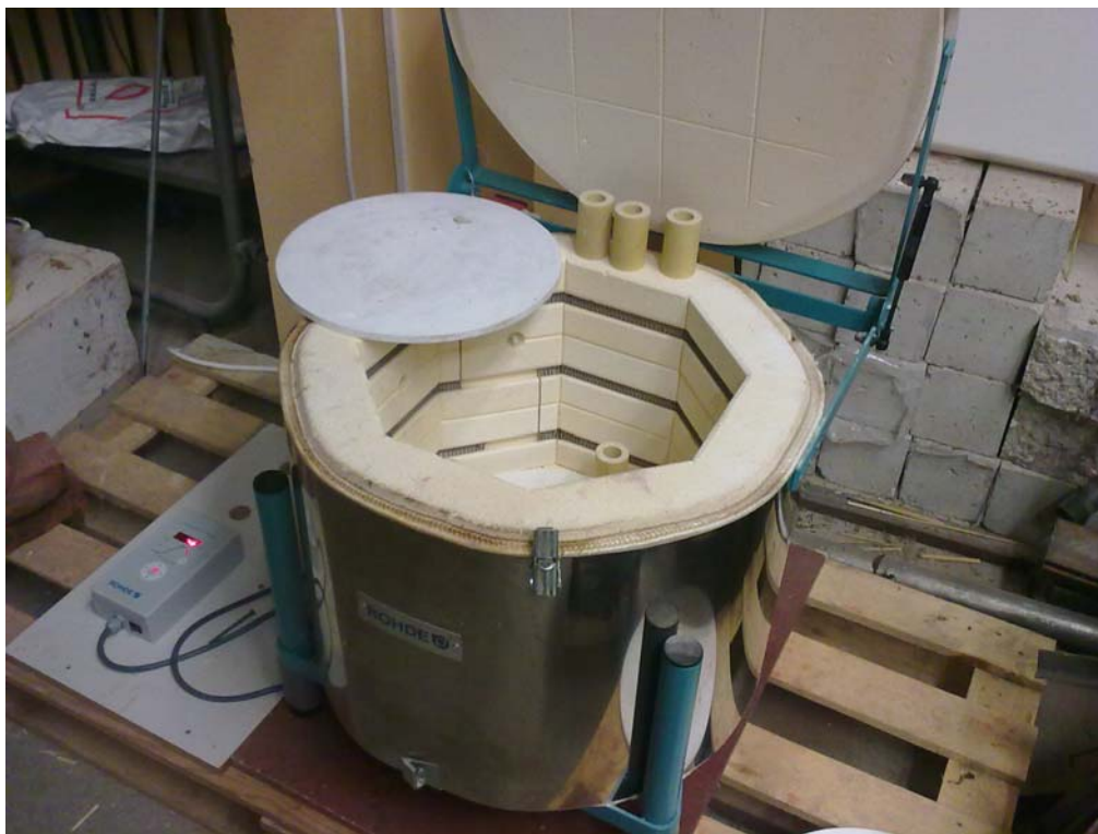
Joonis 2.6 Automaatikaga keraamikaahi, milles põletati lupja
