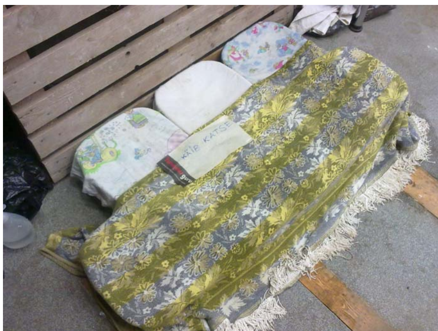
Joonis 2.13 Põletatud lubjaga anumad on niiske keskkonna loomiseks kaetud märgade lappidega
