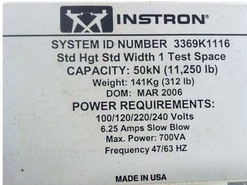
Joonis 3.18 Kasutatud pressi andmed
