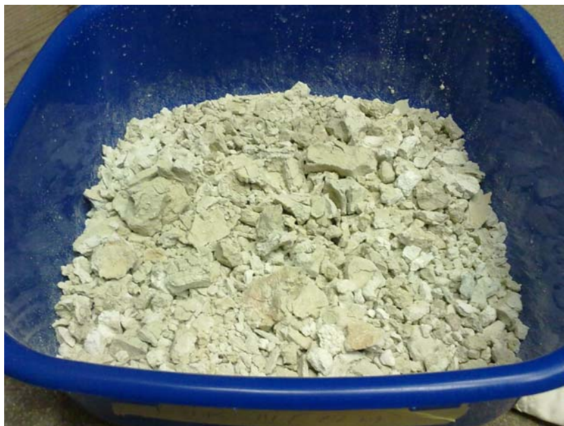
Joonis 2.15 Lubjakivide murenemine kustutamise protsessis 22.04.2010
