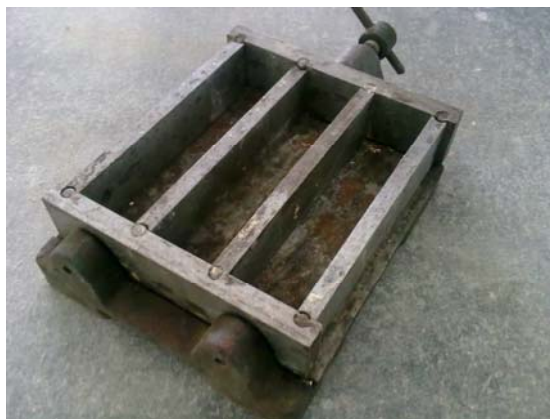
Joonis 3.14 Vorm 160×40×40mm katsekehade valmistamiseks
