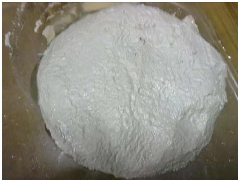
Joonis 3.11 Riigi karjääri lubjast valmistatud katsekeha A2 enne vette panekut
