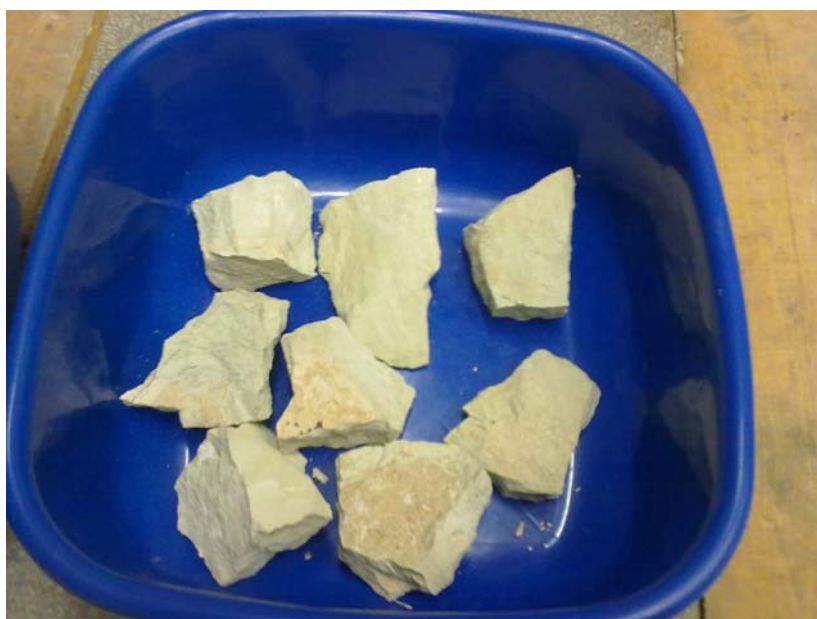
Joonis 2.14 Lubjakivi tükid kustutamise protsessis 19.04.2010
