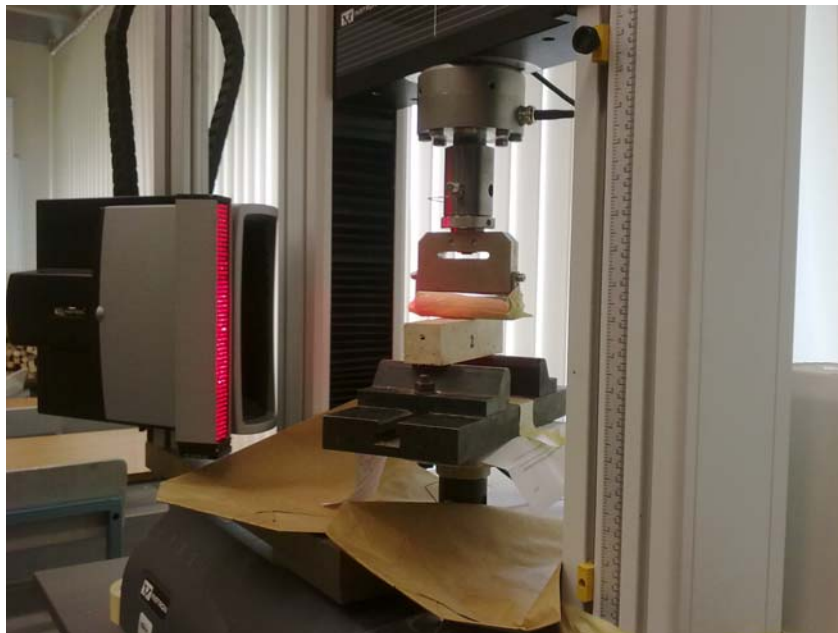
Joonis 3.19 Paindetugevuse määramine
