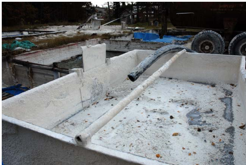
Joonis 1.9 Plekkvann lubja kustutamiseks (30.10.2009, Lea Stroh)
