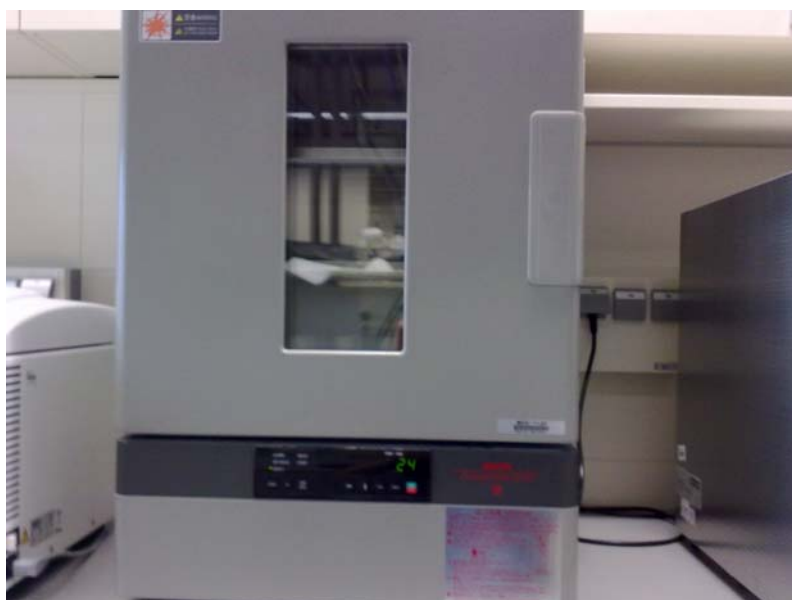
Joonis 3.1 Kuivatuskapp, milles proovid kuivatati
