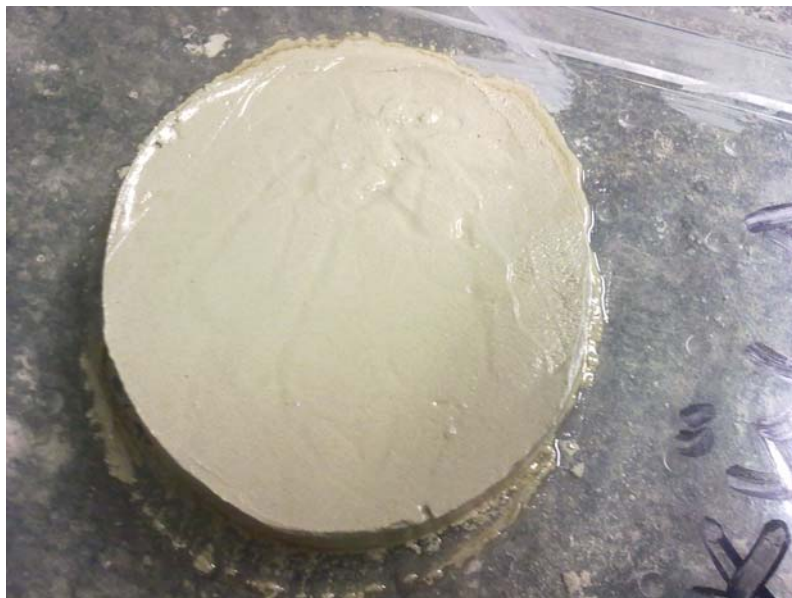
Joonis 3.13 Mõisaküla karjääri lubjast valmistatud katsekeha B2 enne vette panekut
