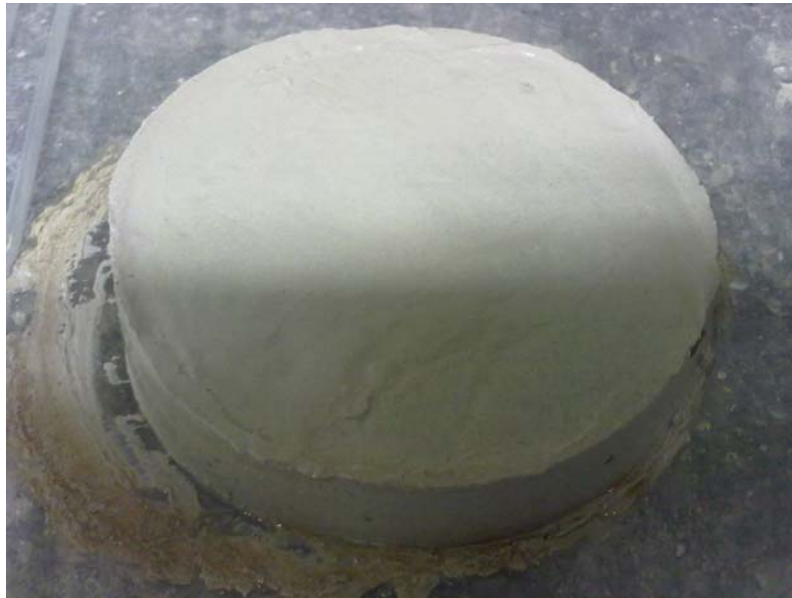
Joonis 3.12 Mõisaküla karjääri lubjast valmistatud katsekeha B1 enne vette panekut
